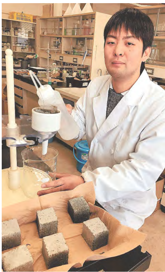
モルタル平板に銅を吸着させる実験を繰り返す平塚さん
